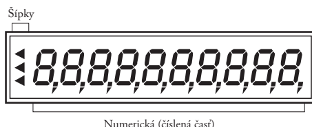
Obrázok 2.5 Rozdelenie segmentového LCD displeja
